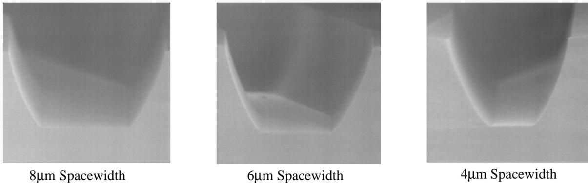
8 $\mu$ m Spacewidth6 $\mu$ m Spacewidth4 $\mu$ m Spacewidth
